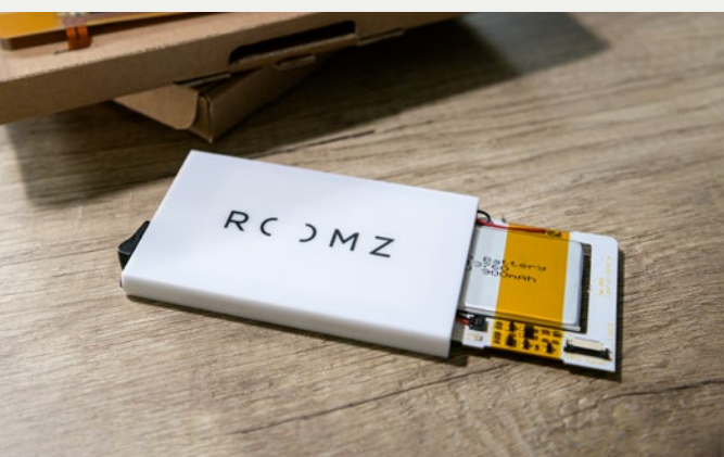
Ladeelektronik mit wiederaufladbarer LiPo-Akkuzelle
